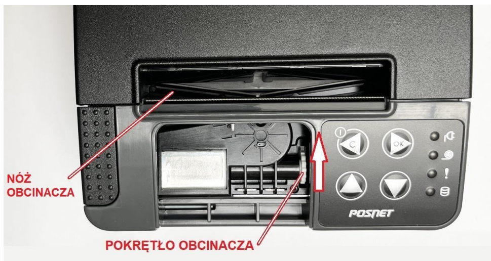
Rys. 6. W celu cofnięcia noża należy obracać pokrętłem obcinacza w kierunku pokazanej strzałką. Obracanie należy kontynuować do momentu schowania noża czyli pojawienia się szczeliny pokazanej strzałką na rysunku 1.
