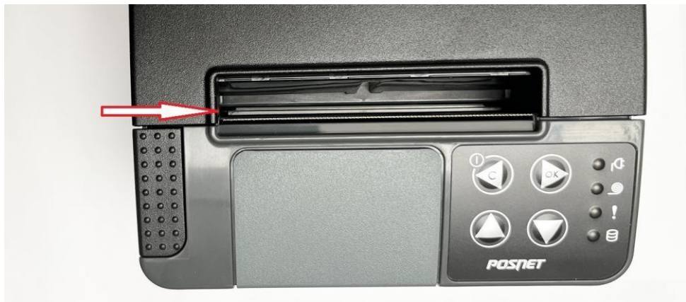
Rys. 1. Nóż obcinacza schowany. W miejscu pokazanym strzałką widoczna jest szczelina
